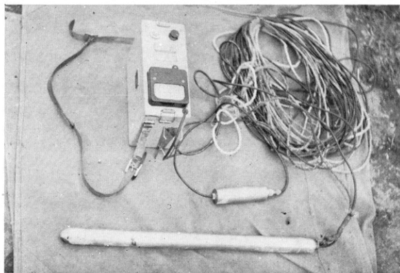
検用ガイガー計数管プローブ （SU-P1型サーベイメーター） （ターに取付けたところ）
