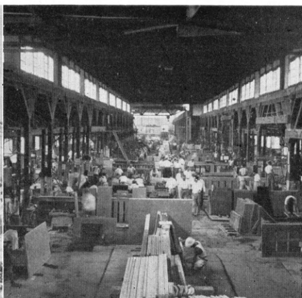
大理石の加工場の内部 切石が4~5 切以上の板石に切斷され研磨されて張石となる
