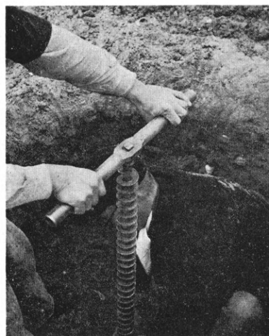
⑤ さらに深く調査するために簡易鉋機を使う（能力1.9m） →
