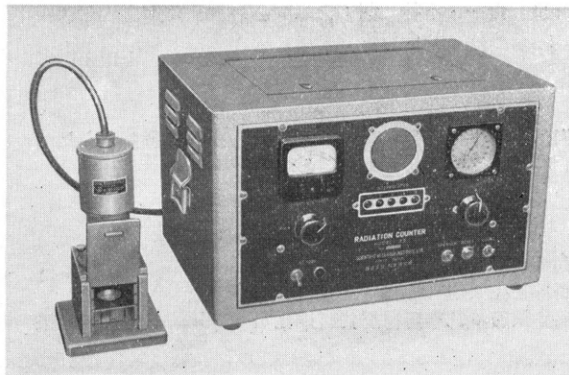
科研ガイガ・ミュラー計数装置 (β線またはγ線を放射しているラジオアイソトープを) (含んだ試料の精密測定用に作られたもの)
