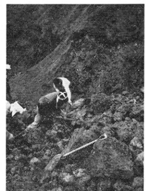
鉬石をピツグ・ハンマーにて破碎する作業
