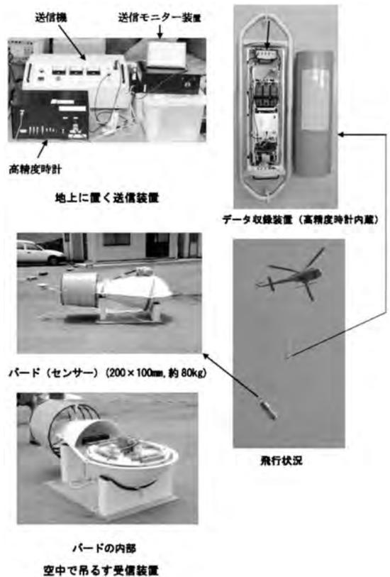
第2図 GREATEM探査に用いる機器類、ヘリコプターへの装着状況。
