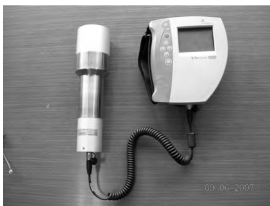
第1図 歩道上放射線測定に用いた米国キャンベラ社製 InSpector1000測定器(右)と、3×3インチNaI放射線検出器(左の筒状器具)。
