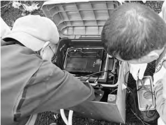
第11図 雷の被害にあった黒焦げのロガーの様子。
