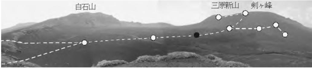
第10図 櫛形山から眺めた伊豆大島山頂火口原南側の様子。丸印は電極の位置(黒丸ではロガー等も設置), 点線は電線の位置を示す。図には表れないが, 南側の裏砂漠まで測線は延びている。
