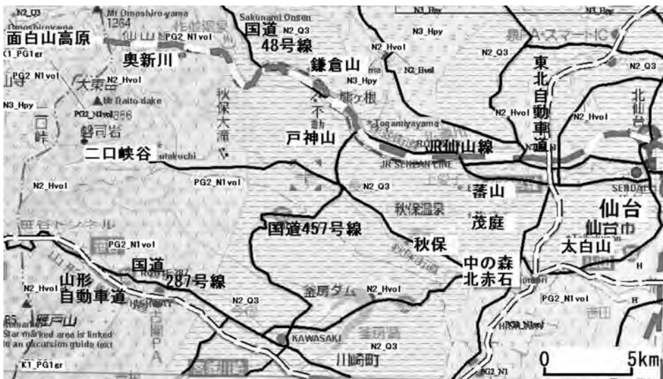
第1図 仙台西部の地質概略図。K1_PG1gr: 白亜紀花こう岩, PG2_N1vol: 前期中新世火山岩, N2_Hvol: 前期第四紀火山岩(安山岩)(図の西側)及び鮮新世火山岩(安山岩)(東側), N2_Q3: 中期-後期中新世堆積岩(凝灰岩, 砂岩, 泥岩), N3_Hpy: 後期中新世凝灰岩, H: 沖積堆積物。地質図の背景はYahoo!の地図を利用。
