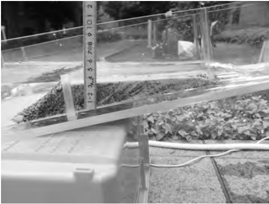
写真2 三角州の前面につくられた前置層(地質標本館で撮影)。地層の傾斜角と、三角州前面の傾斜角はほぼ同一で、ここから安息角について解説することができます。
