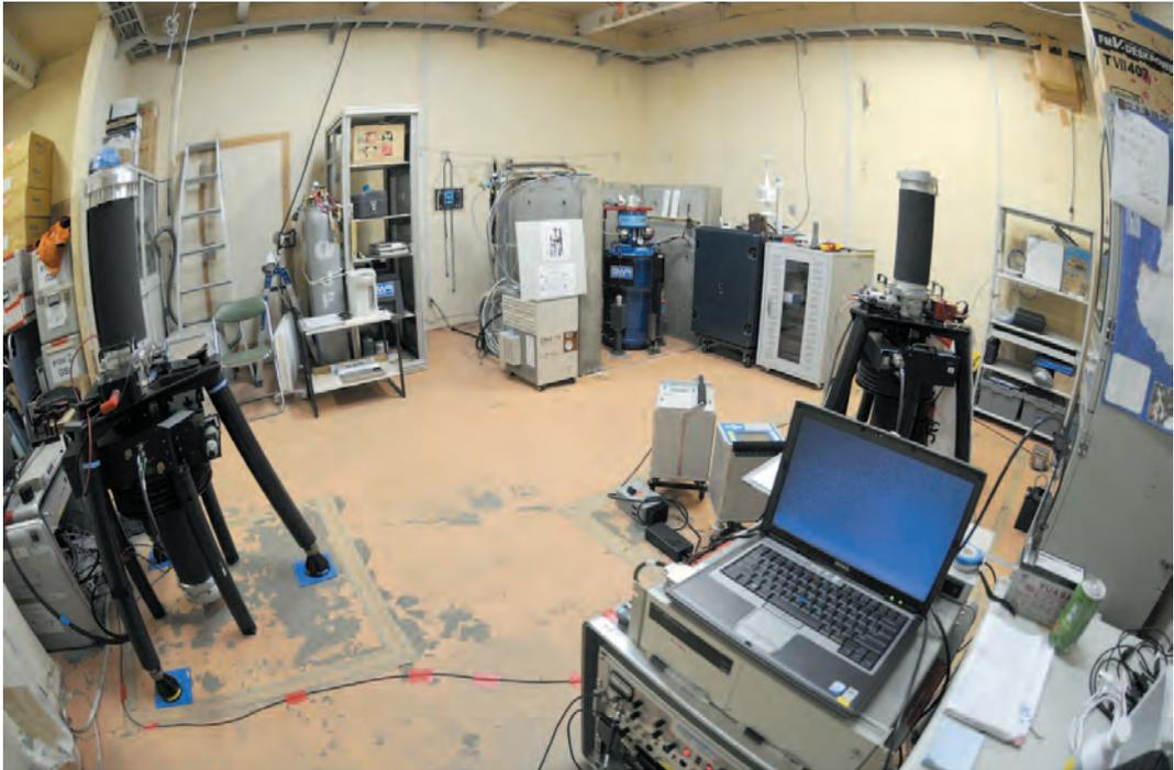
写真1 南極昭和基地の重力計室内。左手前は国際絶対重力基準点基台に設置した絶対重力計、奥に超伝導重力計。右側の予備基台には、絶対重力計と2台の可搬型相対重力計。
