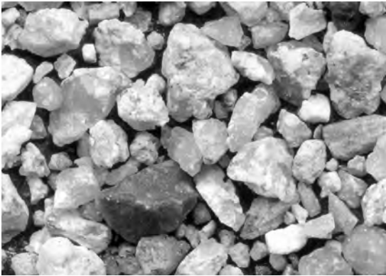
写真14 斐伊川上流の砂，粗い石英・長石からなる砂礫です。(画面の上下が約1cm).
