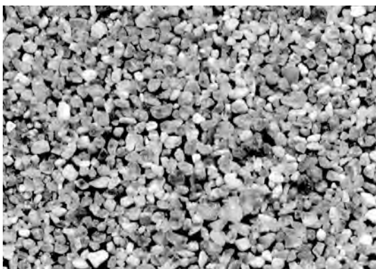
写真34 湖陵砂丘の砂。淡褐色で分級良好な中粒砂です。(画面上下が約1cm)。
