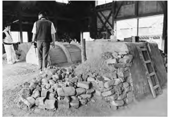
写真17 工場内の日刀保たたら，ここでたたら精錬が行われるのです。
