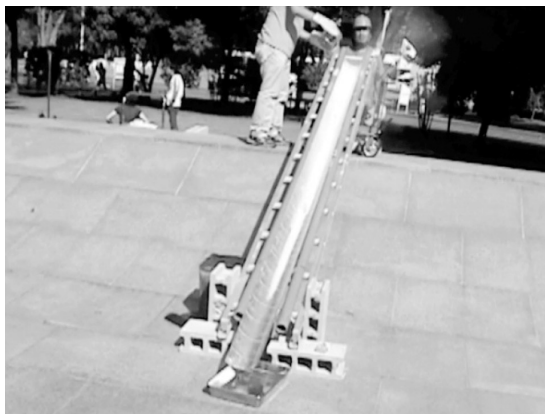
第2図 火砕流「的」現象が発生した瞬間。流れの先端は幅数cmの複数のロープに分岐している。射水路上方の人物の周辺には煙が舞い上がっている。
