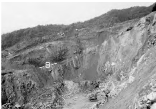
写真4 採掘場の状況。中央に低角の断層(-B-)が良く見えています。
