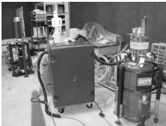
写真4 筑波大学での超伝導重力計(右手前)と絶対重力計FG5/217(左奥)の比較測定。
