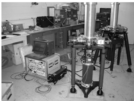
写真2 テーブルマウンテン重力観測所で検定中の2台のFG5。手前がFG5/217。奥は通し番号100番台のFG5。
