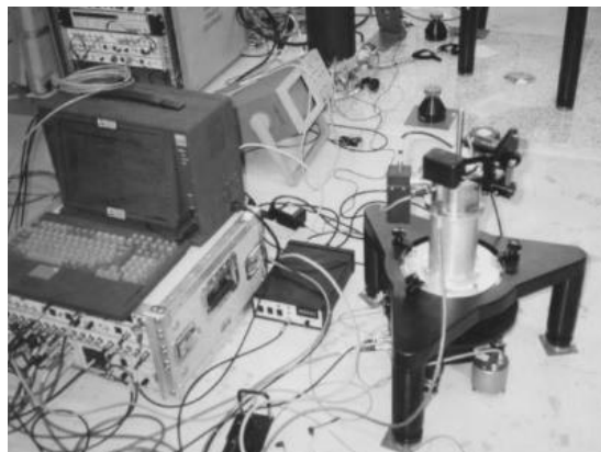
写真1 国土地理院重力棟で計測中の絶対重力計FG5L/003。右側が落下距離7cmの落下槽。その三脚の足元の小さい円筒は地動を評価するための地震計。
