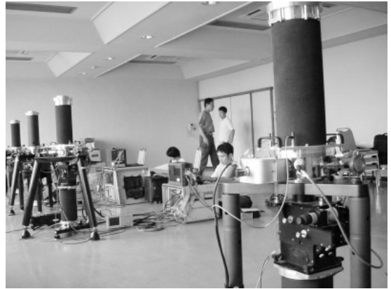
写真3 筑波山比較観測会の様子. 右手前がFG5/217. 左隣はFG5/212. 同じ通し番号200番台のFG5でも落下槽の三脚の形状が異なる.
