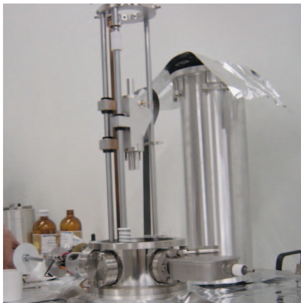
写真1. 絶対重力計FG5では落下槽と呼ばれる真空円筒中に容器を上下させる機構を組み入れてあり、その中で反射体は自由落下する。
