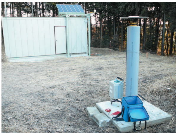
写真4. 小屋全体の大きさは230cm×545cmで、ドアのある右半分に作業スペースも設けた。隣接してGPSアンテナ台も設置した。
