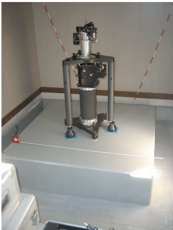
写真3. 重力観測台は小屋の土台と切り離してある。1辺150cmの正方形で、絶対重力計本体の他に相対重力計を設置する余裕がある。なお、写真の絶対重力計は小型落下槽を取り付けた時の状態である。
