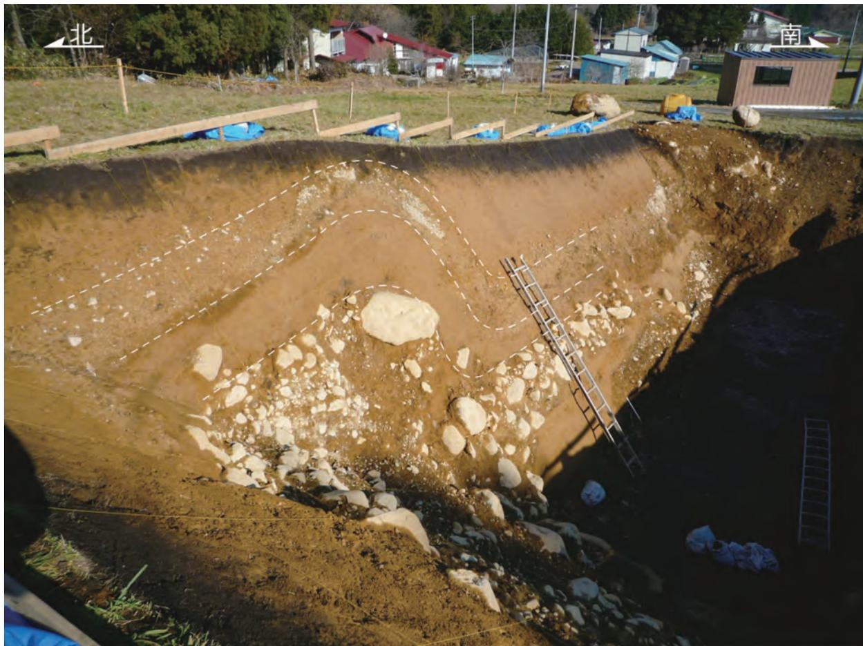
2008年6月14日に発生した岩手・宮城内陸地震では従来活断層が認定されていなかった場所に地震断層が出現しました。一関市巖美町岡山では、上下変位10cm程度の地震断層が、過去の断層活動でできたとみられる比高2～3m程度の崖に沿って現れました。この崖を掘削したところ、地形と調和的な地層の撓曲変形が確認されました。地層の変形パターンから、過去には上下変位量が2m以上と今回よりも明らかに大きい変位を伴う地震イベントがあったことが分かりました(梯子の長さは約4m)。
