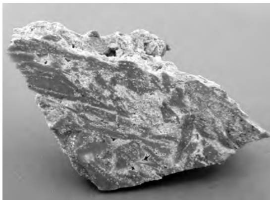
写真7 ろう石鉍(切断面). 雲母粘土鉍物は鉍石の内部にまで形成されています.
