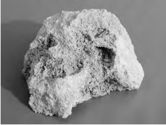
写真1 「世界一」鉱石。試料の左右が約10cm。コークス状で、表面は銀灰色。
