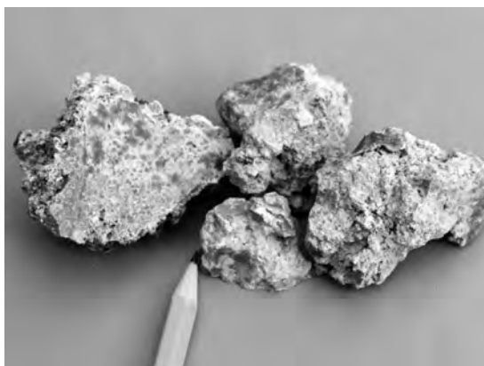
写真8 堇青石を含む鉍石. 淡褐色のコークス状で, 切断すると堇青石が現れます.
