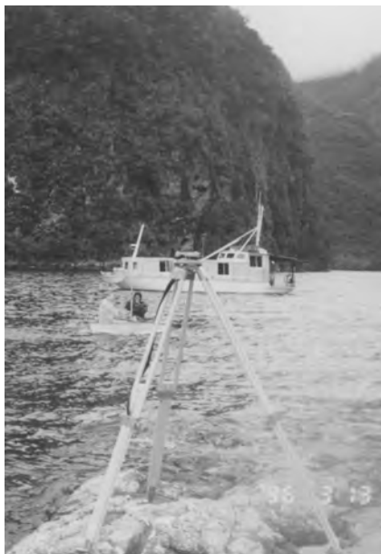
写真2 1回目の計測で、基地局から調査船までボートでGPSアンテナを移動中の様子。
