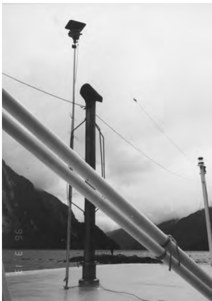
写真3 調査船上にセットしたGPSアンテナ。アンテナの奥に岩礁の基地が見える。
