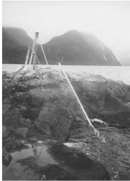
写真1 1回目の測定の基地局の様子。設定した基線の両端には三脚が立てられ、手前の三脚は固定点のGPSアンテナが載っている。標尺は潮位計測のために使用した。
