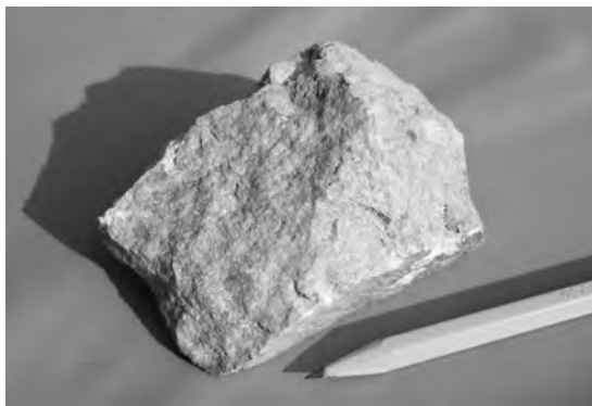
写真5 緻密な珪化岩. 梵天山頂上付近に産出する緻密で硬質な珪化岩.
