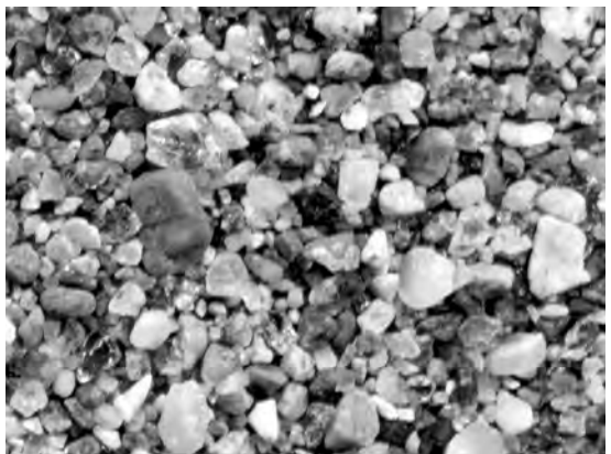
写真11 宮海海岸の砂。分級不良の極粗粒砂でした(画像上下が約1cm)。
