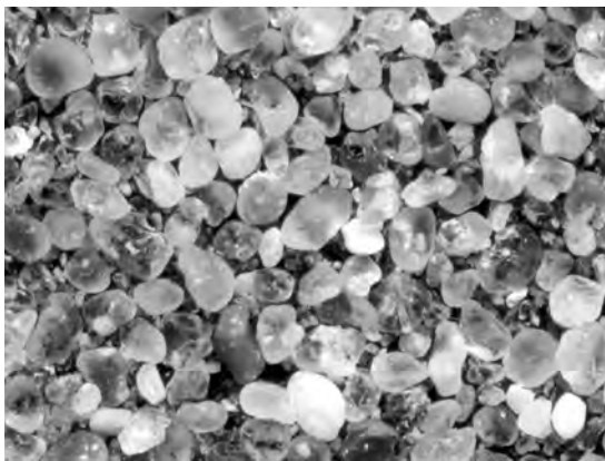
写真3 大石田鉦山の珪砂、原砂を洗浄したもの、大小の粒子が混じる(画面上下が約1cm)。
