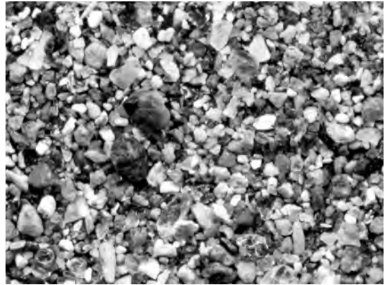
写真13 十里塚海岸の砂、分級不良の粗粒砂でした(画像上下が約1cm)。
