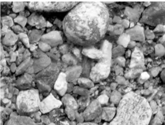
写真6 最上川の砂。円磨・分級不良の砂礫です(画面上下が約1cm)。
