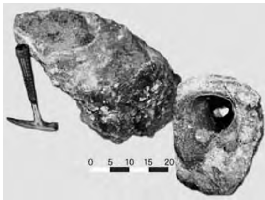
第2図 硫化物チムニー。水曜海山の火口で「第二白嶺丸」により採取。パイプ状の穴がベントで、熱水溶液の通路です。標本が二つあるように見えますが、同じ標本を違った角度から撮影したものです。
