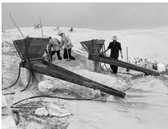
写真3 比重選鉱作業。 砂丘に忽然と現れた比重選鉱器。木で簡単に作られた装置とはいえ、結構濃集するものだ。
