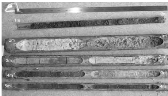
写真2 つくば市内で採取した簡易ボーリングのコア。定規は1m。数字は深さ。層相は0～1.1m:土壌, 1.1～3.1m:粘土, 3.1～3.4m:シルト, 3.4～5.0m:砂。
