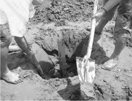
写真13 2007年10月, Line Dにおいて柱状コアを採取している様子。1mの塩ビパイプを木槌で打ち込み, 周囲の砂を除去した後, 力ずくで引っ張り上げる。砂まみれになる作業である。
