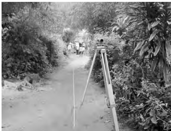
写真6 オートレベルによる地形測量。テープに沿って前を行くのは村上文敏さん率いるGPRチームと地元チャービン省のギャラリーの皆さん。
