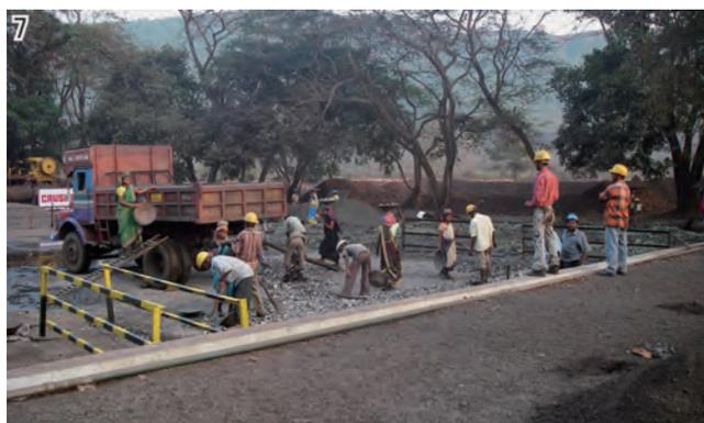
写真7 粉碎したフェロマンガン合金は人の手で品位選別し、トラックへ積まれる。
