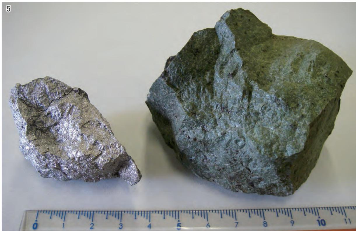
写真5 フェロマンガン合金(左)とスラグ(右)の近接写真。フェロマンガンは金属光沢を持ち、手に持つとズシリと重い。およそ80% Mnおよび8%炭素を主成分とする(公表値)。スラグは淡い緑色を呈し、合金に比べると軽い。スラグはシリコマンガ合金の材料として再利用される。
