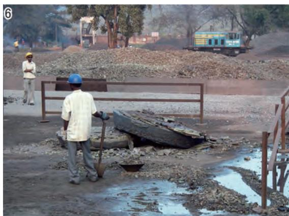
写真6 受け皿から出されたスラグ。まだ湯気がでていた。野外で自然冷却されたあと、ハンマーで砕く。奥のズリ山はこぶし程度に砕かれたスラグ。
