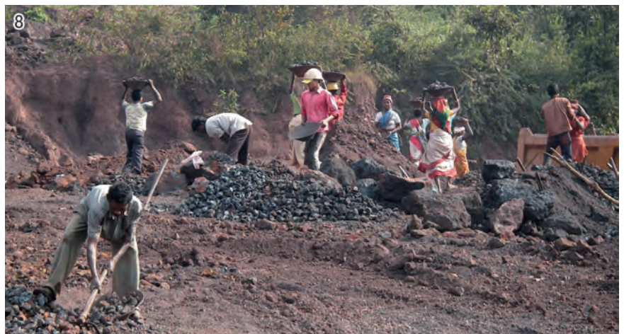
写真8 大部分は重機での採掘のようであったが、一部では労働者の手による粉碎・運搬が行われ右手奥のトラックへ積み込まれる。
