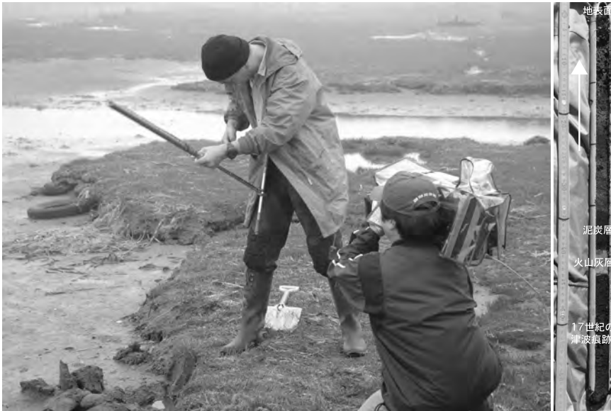
第8図 霧多布湿原での大口径検土杖を用いた探査風景。採取された試料の回収状況を示す。白っぽく見える火山灰層はTa-a (1739年樽前火山起源) およびKo-c2 (1694年北海道駒ヶ岳火山起源) の混在層, その下位の砂層は17世紀の津波痕跡である。図中の矢印は検土杖試料の上位を示す。
