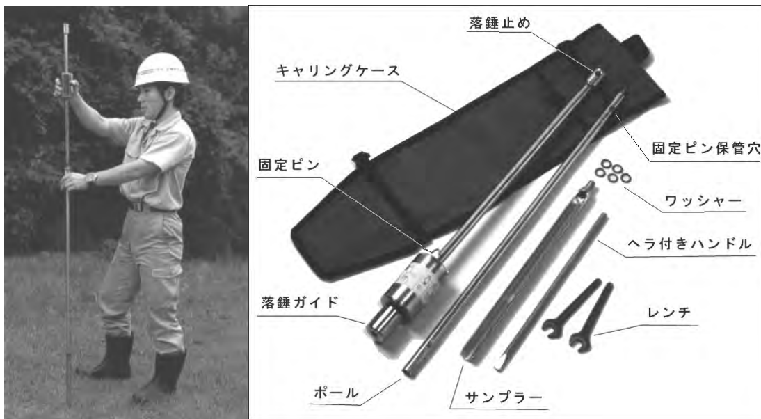
第3図 長谷川式検土杖(ダイウトテクノグリーン(株)製). http://www.daitoutg.co.jp/prd/tool_3.html から図面を引用.
