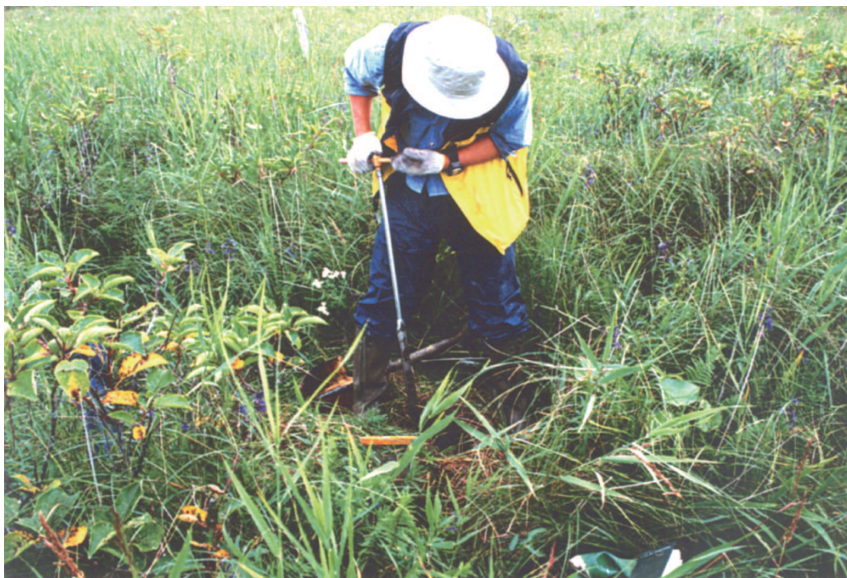
①挿入作業 整地した湿原表面に、ハンドル部に荷重して検土杖を目標深度まで垂直に挿入する。
