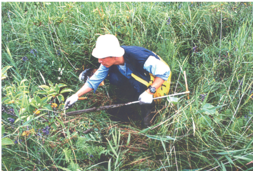
②回収作業 ハンドルを回転させながら引き上げて、サンプラーに収納された柱状試料を回収する。
