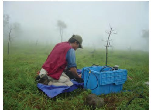
口絵3：MT法調査では夜間にデータを取得する。自動測定のために測定装置のセットアップを行っている。
