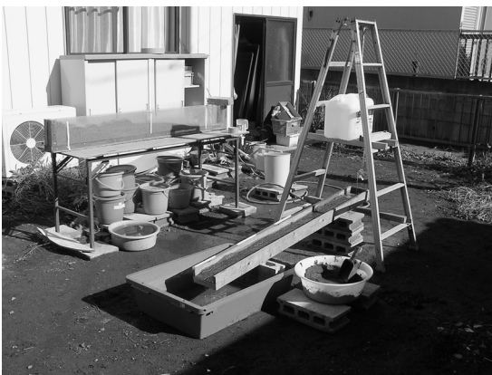
写真1 自宅庭の小型水路(手前)と小型造波水槽(後方)。
