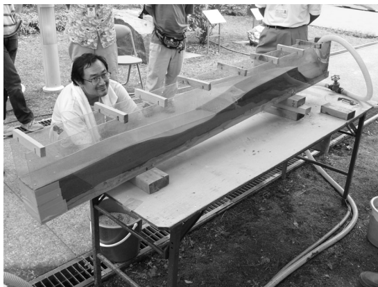
写真4 河床形の実験。
