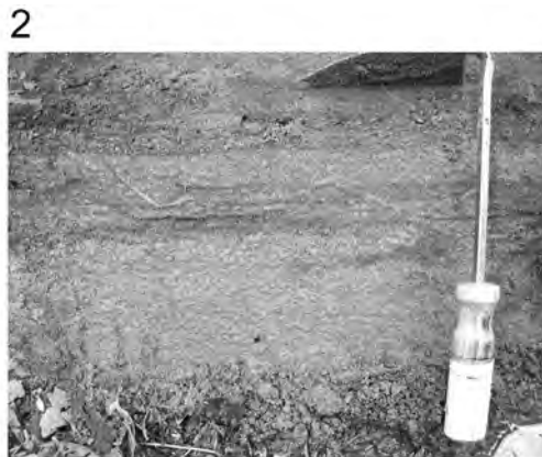
第5図 丘陵を構成する中部の層準の円礫層からなる河成層。成木丘陵を構成する二本竹層。場所は東京都青梅市成木の採石場。礫層の層厚は約30m。
