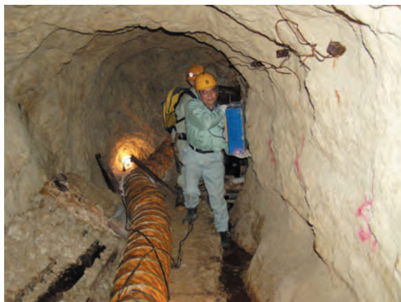
写真2 坑道での地中レーダ探査の様子。観測者はパソコン上でリアルタイムにデータを確認し(上), アンテナを二人がかりで起伏の大きな坑壁に押さえつけながら移動させる(中・下)。
