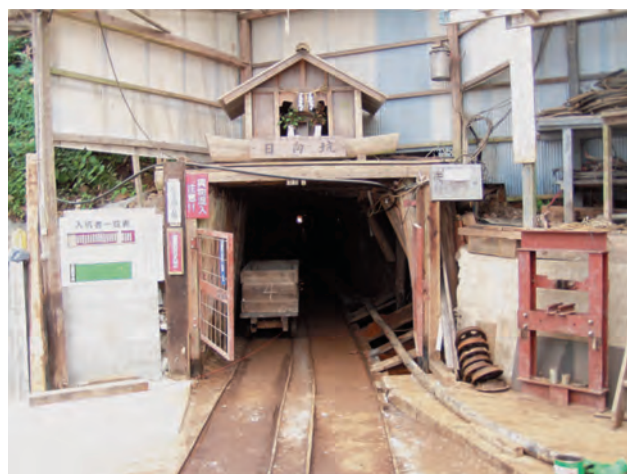
写真1 日向坑の入り口。採掘されたセリサイトの運搬には手押し車のトロックが使われている。
