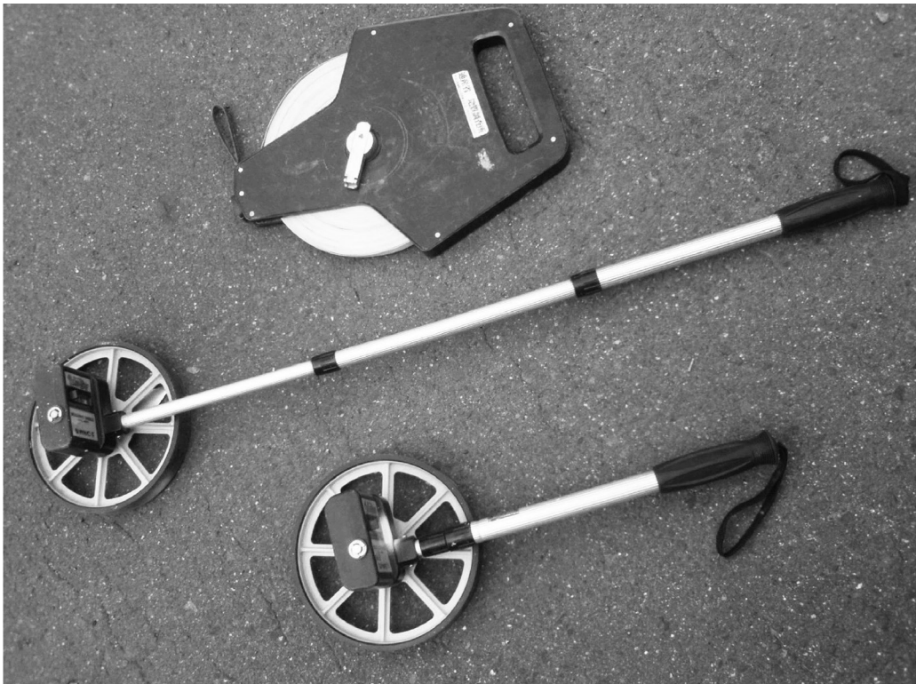
第1図 ホイールメジャと100m巻尺。ホイールメジャは伸縮可能で、携帯や収納でも巻尺並みの便利さ(中央がハンドルを伸ばした状態、下が縮めた状態)。距離表示部はホイールの軸部に直結され、使用時はやや俯き加減に歩きます。
