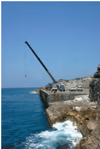
写真4 波が荒いため船は接岸出来ず、貨物や乗客はクレーンで運ばれる。
