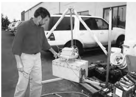
第31図 ヘリコプター可搬型観測装置、スパイダー。三脚の頂点には吊り下げるためのフックが付いています。GPSアンテナは右の柱の上に取り付けます。説明するのはUSGSのScott氏。
