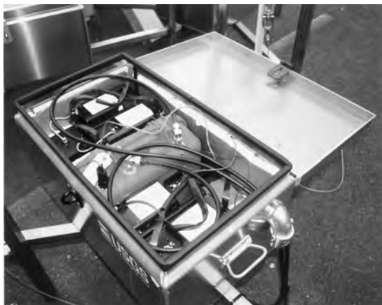
第30図 野外観測のためのGPSと地震計の記録装置を収納する金属製の箱。
