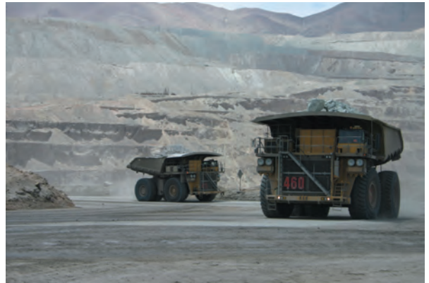
2. オープンピットからズリを搬出する330トンドンプトラック。鉱石はオープンピットの中腹からトンネルで選鉱プラントに運搬される。
