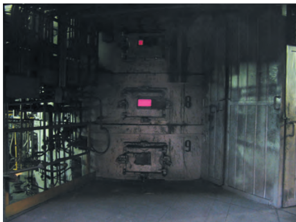
6. Chuquicamata製錬所内のモリブデン焙焼炉. 650℃以上でモリブデン精鉱を焙焼し品位57-58%の三酸化モリブデンを生産.
