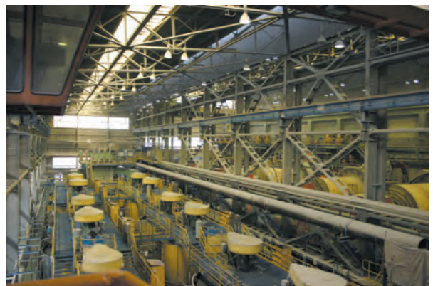
4. Chuquicamata鉱山選鉱プラント浮遊選鉱機。モリブデンは銅精鉱にNaHSを加え銅と分離する。この過程でモリブデンは品位約50%に濃縮される。
