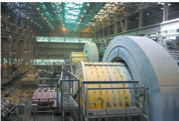
3. Chuquicamata鉱山選鉱プラントSAGミル（鉱石と鉄球を混ぜ鉱石同士でも破碎する）。
