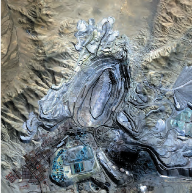
1. 世界最大のモリブデン生産を誇るChuquicamata鉱山オープンピット。南北4.3km、東西2.7km、深さ870mで世界最大規模の露天採掘鉱山。2013年にオープンピットから坑内採掘に切替え深部に連続する鉱床を採掘することになっている。右下の黒ずんだ所に製錬所と選鉱プラントがある。
