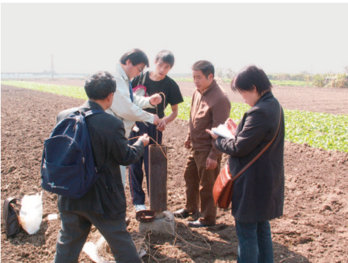
写真2 陕西省西安市北郊曹家堡南の井戸（深度30m）に採水器を下ろしている様子。
