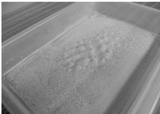
写真8 プラスチックトレー内にできた砂の高まり。
