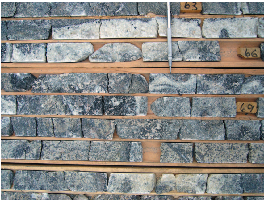
5. カーボナタイトのボーリングコア. 粗粒の炭酸塩鉱物(方解石または sovite)は白色を呈し, Naに富むエジリン輝石, フログパイト, アパタイト, ネフェリン, モンチセリ橄欖石, パイロクロアなどを含む部分は小豆色から黒色を呈している.
