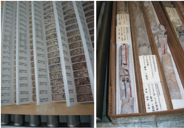
17. (左) 未固結試料は、チップトレイ等で整理される。(右) 試錐コアの欠落部や研究用に持ち出された部分には、必ずその理由や所在が書き込まれたラベルがはめ込まれる。
