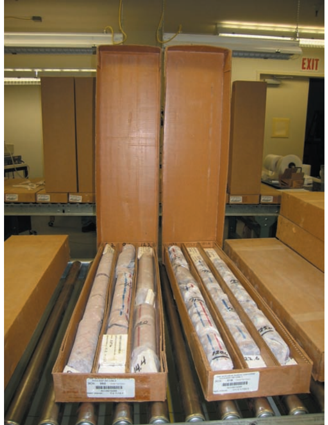
18. 試錐コアは、紙製のコア箱に入れられ、バーコードで管理される。試料には、深度が直接書き込まれ、順序が入れ替わるミスを防止している。また、長さが短い試料は、青・赤のラインが左右に引かれ、試料の上下が入れ替わるミスも防止している。
