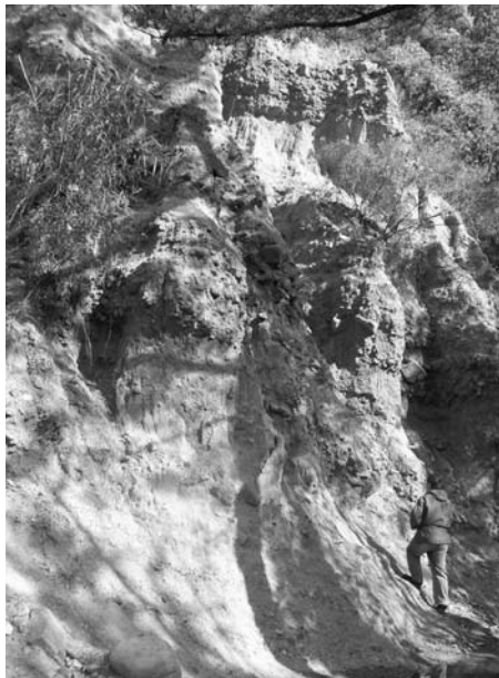
写真7 沖積錐堆積物(露頭JR-1). 角礫の多い層とそうでない層が互層している.
