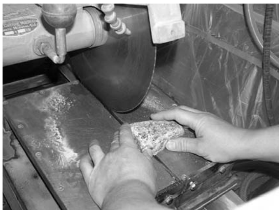
写真1 岩石を切断して整形。
