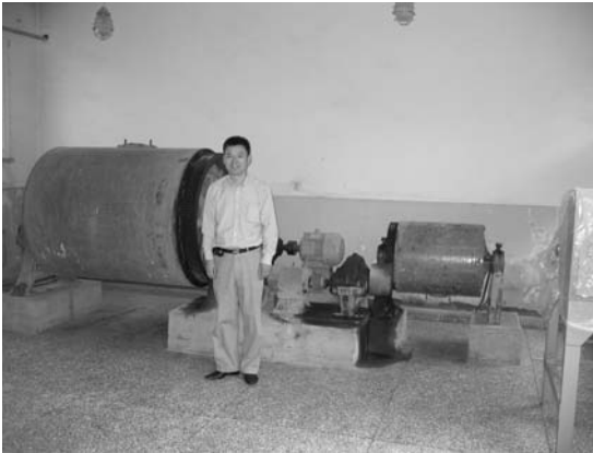
第11図 標準試料作成に用いられている大型ボールミル2台とWang Xueqiu (王 学求) 博士。ボールミルの内張りとボールはアルミナ製。
