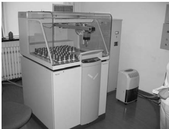
第7図 地球化学図作成の主要分析装置である蛍光X線分析装置。研究所には蛍光X線分析装置が2台あるが、写真は2005年に設置されたもの。
