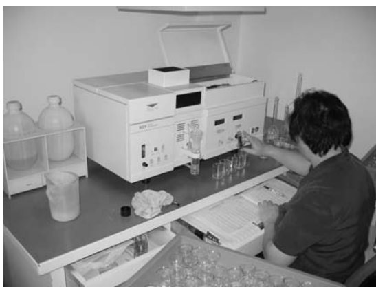
第8図 原子蛍光分光装置 (Atomic Fluorescence Spectrometry)。地球物理地球化学探査研究所で開発、製造された装置。As, Bi, Hg, Sbの分析に威力を発揮している。
