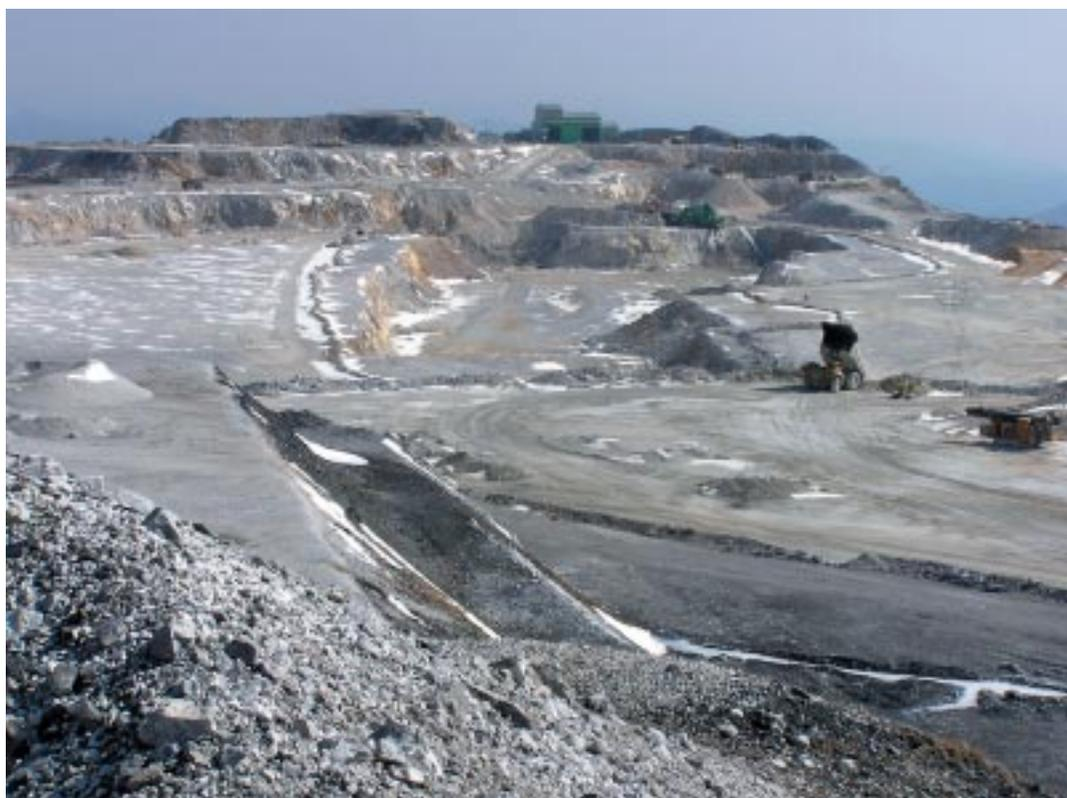
4. 採掘場中央部から東端部を望む。1.2km先の東端には巨大なダンプや重機のための巨大な整備庫がある。荷台をあげて竖坑No.2に鉱石を投入しているダンプ・トラックが右中央に見える。
