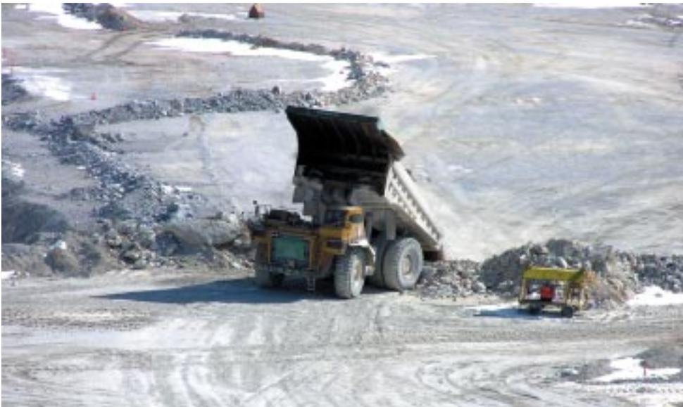
7. 石灰石の豎坑への投入。石灰石を満載したダンプトラックは500m程走ったところにある豎坑に石灰石を投入し、すぐさま積み込み場所へ引き返す。
