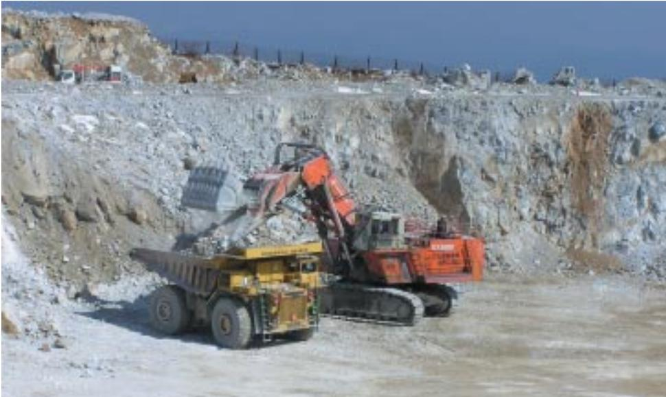
6. 石灰石の積み込み。120トン積みの超大型ダンプの大きな荷台も、巨大なバケットローダーによる積み込みでたちまち満杯になる。
