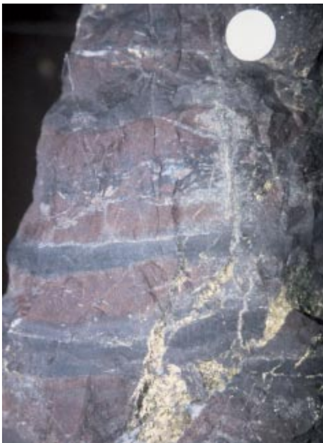
7. JC層. 赤鉄鋳と磁鉄鋳の層状沈殿物を切って黄銅鋳が鋳化した. スケールのコイン直径は2cm.
