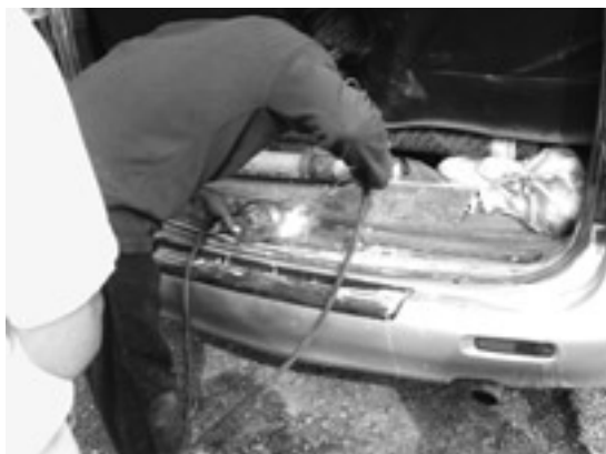
写真15 ドアを修理中。後ろのドアをロックする金具が壊れてしまいました。走行中にドアが閉まりません。近くの村で、応急措置です。なんと素手で溶接しています。
