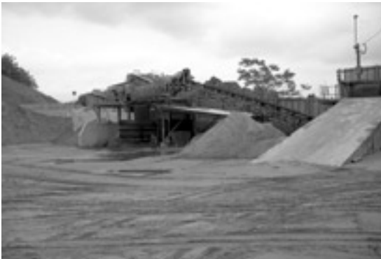
写真6 吹上砂丘の山砂採取場. 採取された砂はこのよう簡単なプラントでゴミや礫が除去されて出荷される.
