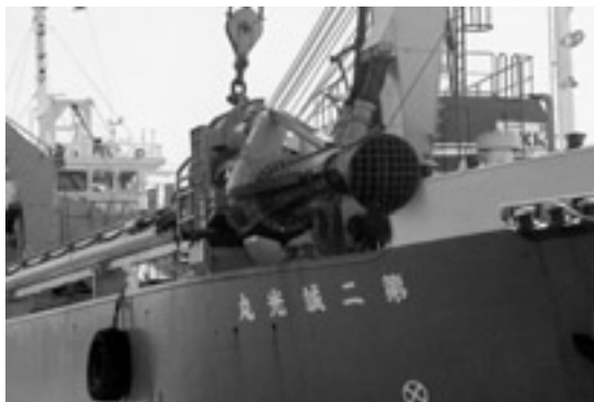
写真24 砂利採取船に装備されている水中ポンプ。
