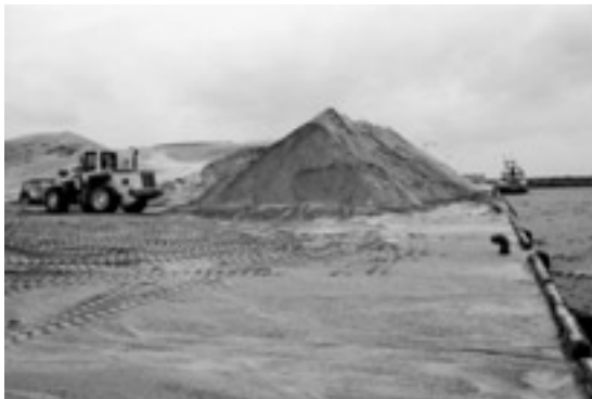
写真1 串木野新港の砂利埠頭。串木野から吹上浜の沖で採取された海砂が陸揚げされている。
