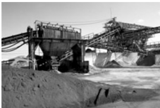
写真25 海砂プラント。陸揚げされた海砂は篩分けや洗浄されて、生コンの材料となる。
