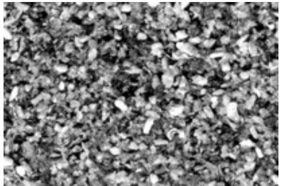
写真11 万之瀬川河口付近の砂(画面の左右が1.4cm). 風で吹き寄せられた砂は粒が揃っている.
