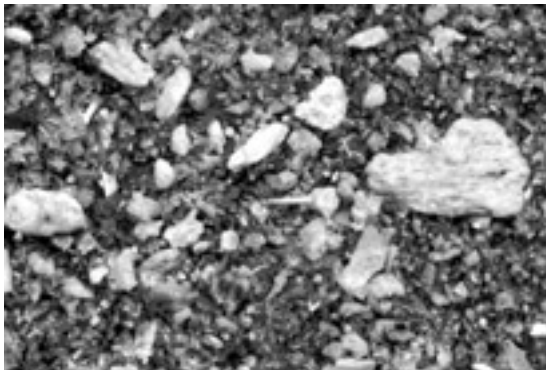
写真9 吹上浜の砂(画面の左右が1.4cm).
